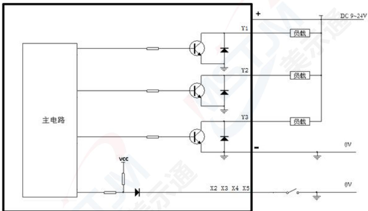
输入输出端口进 PLC (注意: PLC 输入口需要是漏型或混合式), 如下图:
