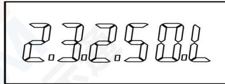
“2.3.2.50.L”表示: 当 1 号测头数据超过**最小值(起点)**0.1mm 时开始计时自动判断输出, 如果 0.3 秒内数据变化不超过 **0.01mm**, 则输出公差结果, 反之, 不输出; 但如果超过 **50 秒**后强行输出公差结果;
